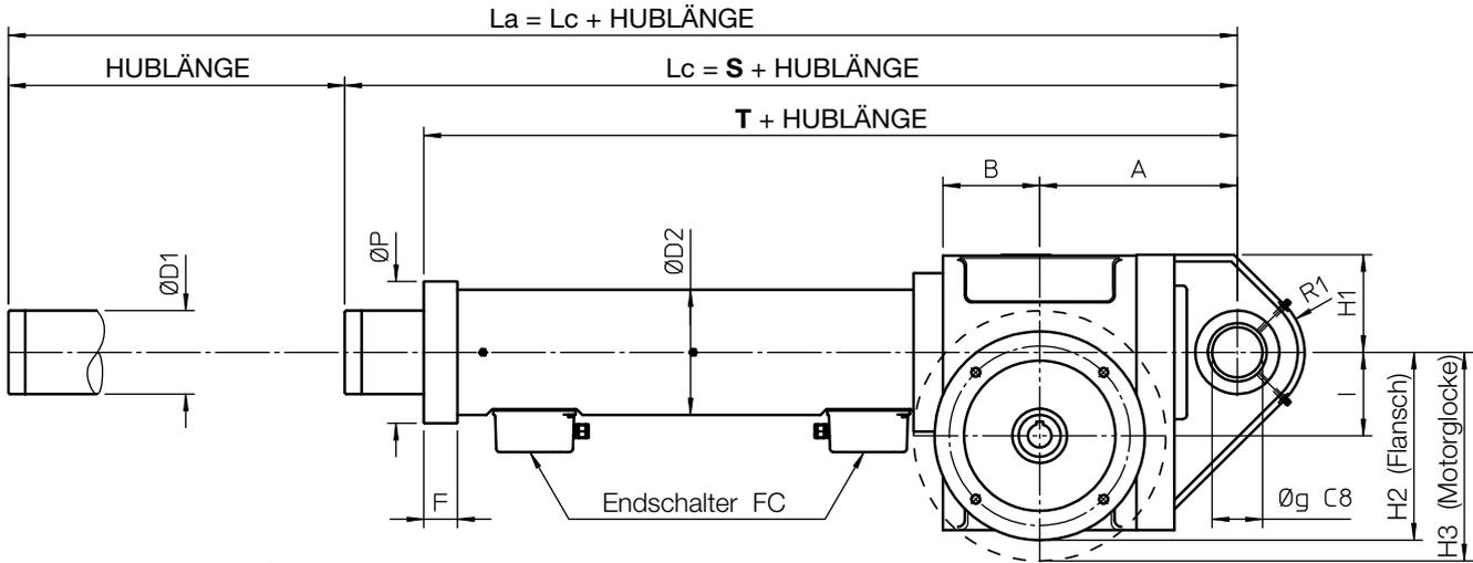
Lc - Länge des EINGEFAHRENEN LINEARANTRIEBES
