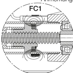
Anmerkungen: - Der Aufbau mehrerer magnetischer REEDSCHALTER ist möglich, um verschiedene Positionen zu erkennen.
