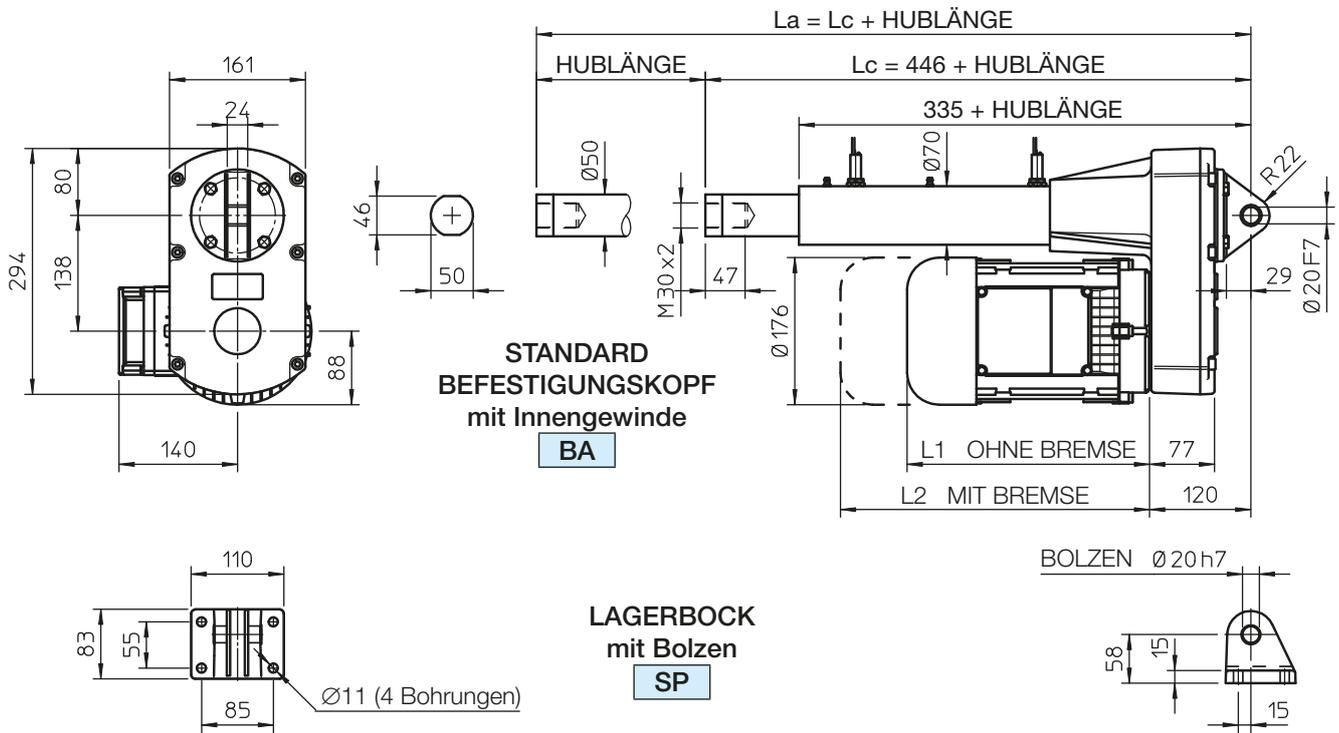
$L_c$  - Länge des EINGEFAHRENEN LINEARANTRIEBES
