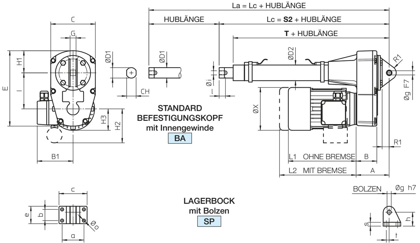
Lc - Länge des EINGEFahrenen LINEARANTRIEBES
