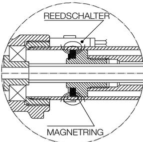
Ein auf der Bronze Laufmutter befestigter Magnetring erzeugt ein Magnetfeld, das den Reedschalter aktiviert. Diese Schalter werden mittels Klemmen am Schutzrohr befestigt. Die Position der Endschalter auf dem Schutzrohr ist sehr einfach einzustellen. Die Endschalter, die für ein zusätzliches, mittleres Positionssignal (zwischen Lc und La) verwendet werden, geben sowohl beim Ein- als auch beim Ausfahren des Antriebes ein Signal in unterschiedlicher Position ab.
