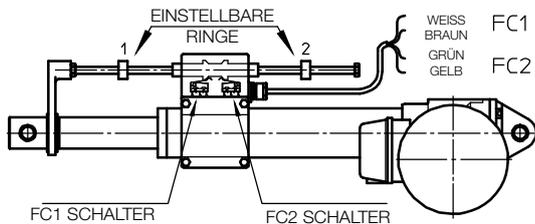
Zwei elektrische, in einem abgedichteten Plastikgehäuse integrierte Endschalter werden durch 2 spezielle einstellbare Ring-Endanschläge aktiviert.
