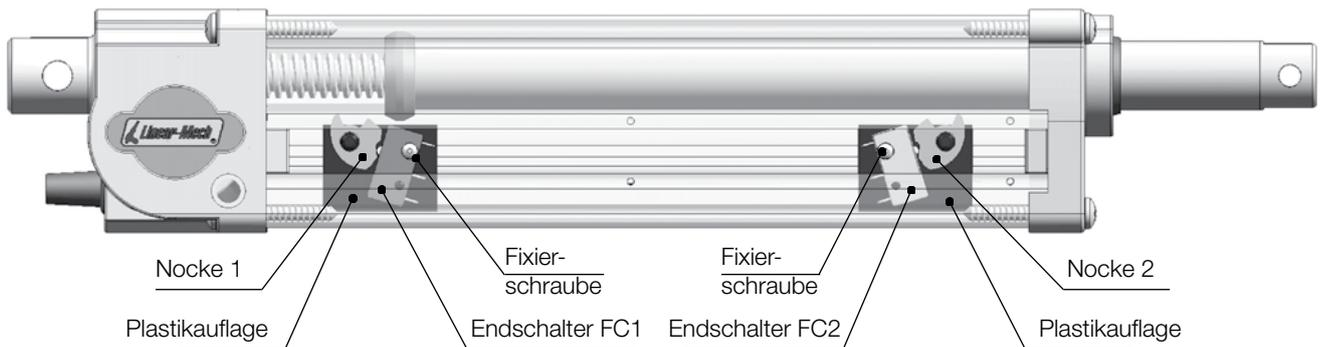
Folgende Abbildungen zeigen eine Schaltfunktion eines FC2 Endschalters.
