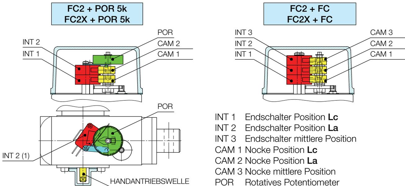
**Lc** = eingefahrene Länge, **La = Lc + Hub** – Abmessungen des Antriebes
